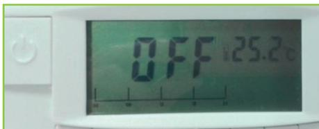
En modo OFF el termostato deja de ejecutar todas las programaciones establecidas, mostrando únicamente en pantalla el valor de la temperatura del ambiente.
