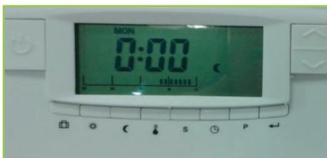
Retirando la tapa exterior se encuentran los botones que permiten configurar y programar el termostato. La programación definida es mostrada en todo momento mediante un segmento de barras, permitiendo elegir en cada periodo el modo deseado por el usuario (confort o económico).
