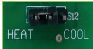
En la parte interna del termostato se encuentra el jumper de selección para su ajuste en función del uso al que se valla a ser destinado, debiendo así elegir entre calefacción (heat) o aire acondicionado (cool).
