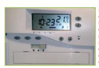
Retirando la tapa frontal, se encuentran los botones para la puesta en fecha y hora, configuración de los programas deseados y selector de la función frío, calor o apagado; así como el espacio destinado a la colocación de las pilas.
