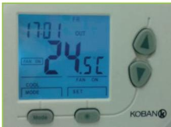
En pantalla aparece reflejado la fecha y hora, temperatura ambiente, modo de funcionamiento actual (frío/calor), tipo de programa ejecutado, activación o no de anulación de programa, activación o no de la función ventilador.
