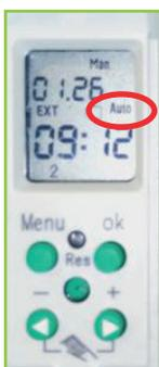
Además de permitir múltiples programaciones, dispone de la opción de seleccionar modo de funcionamiento permanentemente encendido, permanentemente apagado o según la programación establecida.
