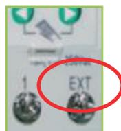
Esta borna permite controlar la carga conectada al programador mediante un pulsador externo, haciendo que se encienda sin tener en cuenta la programación establecida.
