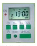
Este interruptor horario permite introducir hasta 16 diferentes programaciones completas, con sus correspondientes encendidos y apagados. Incorpora distintos predefinidos de días de la semana para poder ajustar la programación realizada en función de las necesidades requeridas en cada caso.
