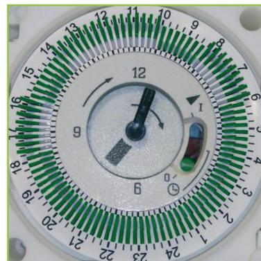
La programación realizada mediante las uñetas indica que la carga asociada al interruptor permanezca encendida durante varios intervalos de tiempo, de 6:00 a 8:00, de 10:00 a 14:00 y de 16:00 a 18:00.
