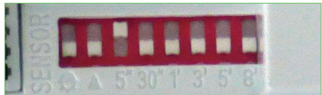
Dispone de selectores regulables de luminosidad, sensibilidad de la distancia de detección y tiempo de apagado de la carga, los cuales pueden adaptarse en función de las necesidades requeridas en cada aplicación.
