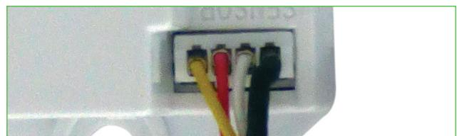
Bornas para la conexión del cableado.
