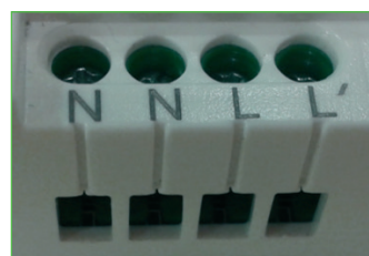
Bornas para la conexión del cableado.
