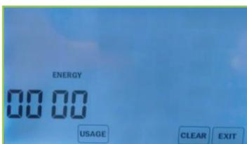
Mediante la opción mostrada en pantalla es posible registrar el número de horas de funcionamiento de la calefacción y/o aire acondicionado. Este registro comienza al activarse el funcionamiento del termostato.
