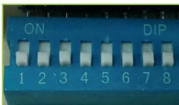
Tanto el transmisor como el receptor disponen de un jumper para la selección de la dirección, de modo que el receptor ignora cualquier mensaje procedente de otra dirección diferente a la ajustada.
