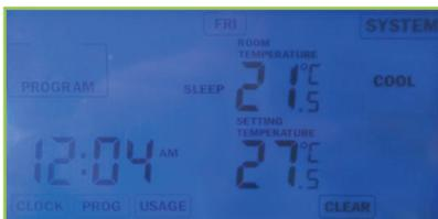
El termostato muestra en pantalla la fecha y hora, modo de trabajo: frío/calor y automático/anulación, temperatura ambiente, así como la temperatura programada.
