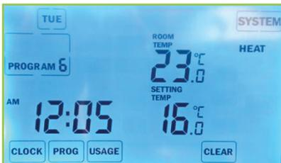
El termostato muestra en pantalla la fecha y hora, modo de trabajo: frío/calor y automático/anulación, temperatura ambiente, así como la temperatura programada.
