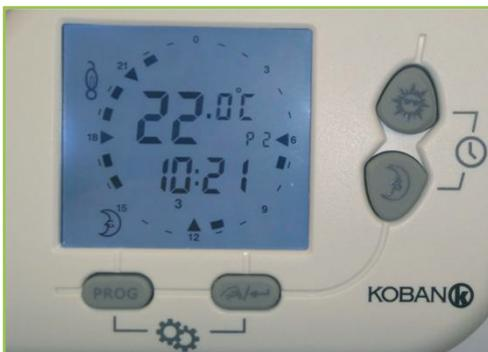
El termostato muestra en todo momento en su pantalla retroiluminada la fecha y hora así como la temperatura actual; la programación establecida según la cual se rige el termostato también es indicada en la pantalla.
