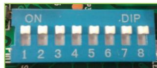
Selectores internos para la configuración inicial del termostato, en función de las características o uso deseado.
