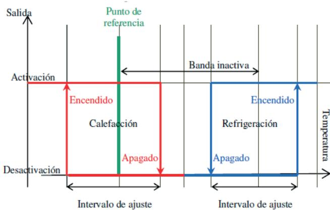
El intervalo de ajuste tanto de la temperatura de calefacción, como de la temperatura de refrigeración puede ser ajustado manualmente mediante los selectores internos.
