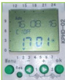
Muestra el estado de funcionamiento de los diferentes canales. Mediante un sol se indica que se está teniendo en cuenta el horario de verano.
