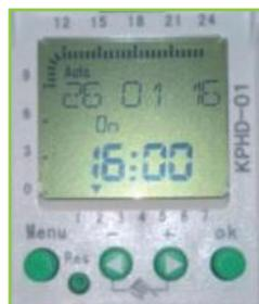
Indicación mediante barra de segmentos del estado de conexión, en función de la programación establecida.
