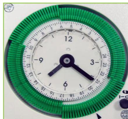
La programación realizada mediante las uñetas indica que la carga asociada al interruptor permanecerá encendida durante varios intervalos de tiempo, de 6:00 a 10:00 y de 17:00 a 22:00.
