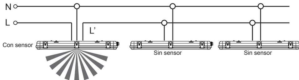
**ESQUEMA DE CONEXIÓN**
