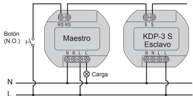
\* Pueden conectarse hasta un máximo de 10 detectores con función Esclavo
