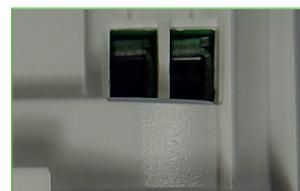
Borna para la conexión de los canales.
