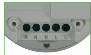
Bornas para la conexión del cableado.
